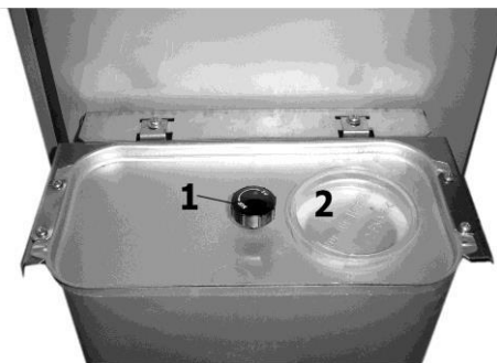
Abbildung 22: Öltank 1 Tankabsperrventil 2 Tanksteckdeckel
