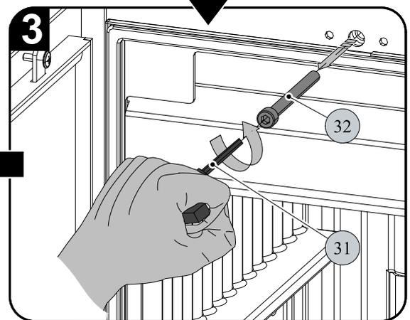
2. Eigentliche Reinigung und Arretierung der Reinigungsplatte
