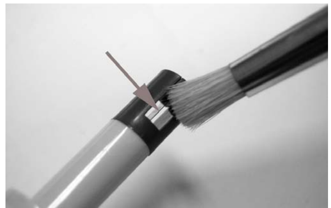
Abbildung 8b: Luftmengensensor Reinigung
