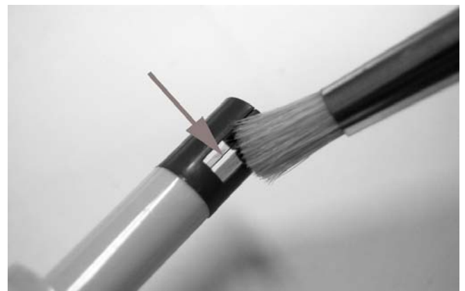
Abbildung 8b: Luftmengensensor Reinigung
