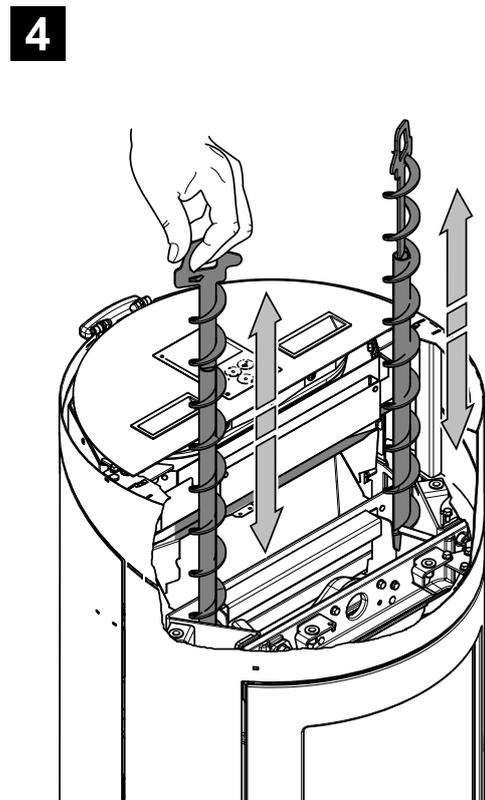
**Abbildung 4: Demontage und Turbulator rütteln**
