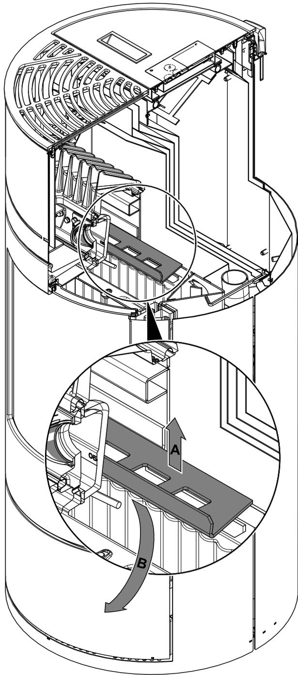
Abbildung 1: Demontage der Zugumlenkung
